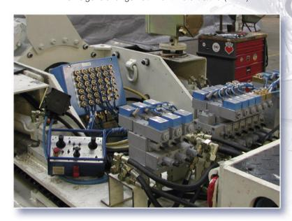
Eigensichere Ventilmagnete iEA33 auf einem hydraulischem Steuerblock zur Ansteuerung eines elektro-hydraulisch angetriebenen Bohrwagens im Untertagebereich
