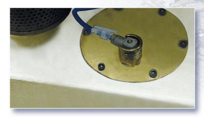
Temperaturüberwachung des Schmieröls in einem Schraubenverdichter
